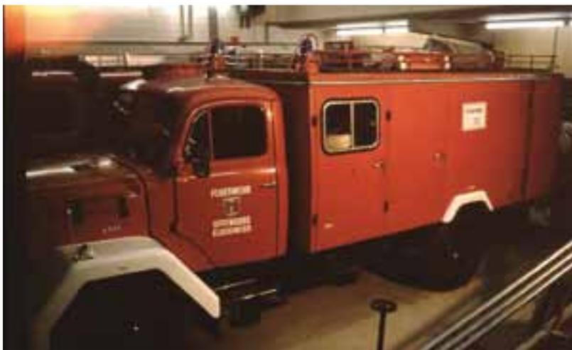
Am 21.02.1989 war es dann soweit. Das „neue“ Fahrzeug, ein Schlauchwagen SW 2000, BJ 1961, der einst vom Bund für den Katastrophenschutz angeschafft wurde, mit 2000 m während langsamer Fahrt auslegbaren B-Schläuchen und einer guten Tragkraftspritze wurde der Abteilung überstellt.
